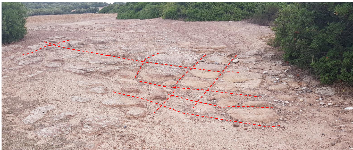
Figura 5.4 Rioliti di Seruci in affioramento e relative discontinuità
